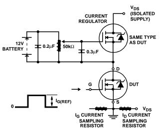
FIGURE 19. GATE CHARGE TEST CIRCUIT
