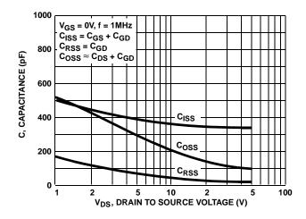
FIGURE 11. CAPACITANCE vs DRAIN TO SOURCE VOLTAGE
