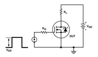
FIGURE 17. SWITCHING TIME TEST CIRCUIT
