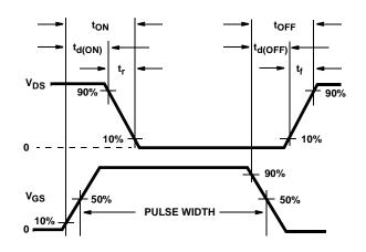
FIGURE 18. RESISTIVE SWITCHING WAVEFORMS
