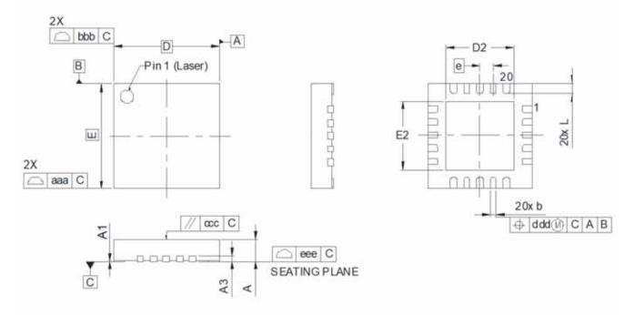
Figure 20. 20-Pin Quad Flat No-Lead (QFN)
