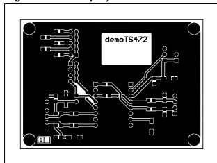
Figure 41. PCB bottom layer
